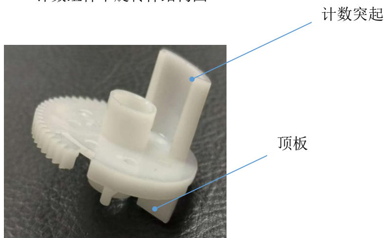
计数组件中旋转件结构图
